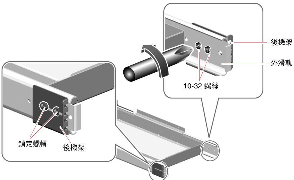
**4. 對於每個短後機架，請使用兩個 10-32 螺絲與鎖定螺帽將兩個短後機架固定到外滑軌。**
