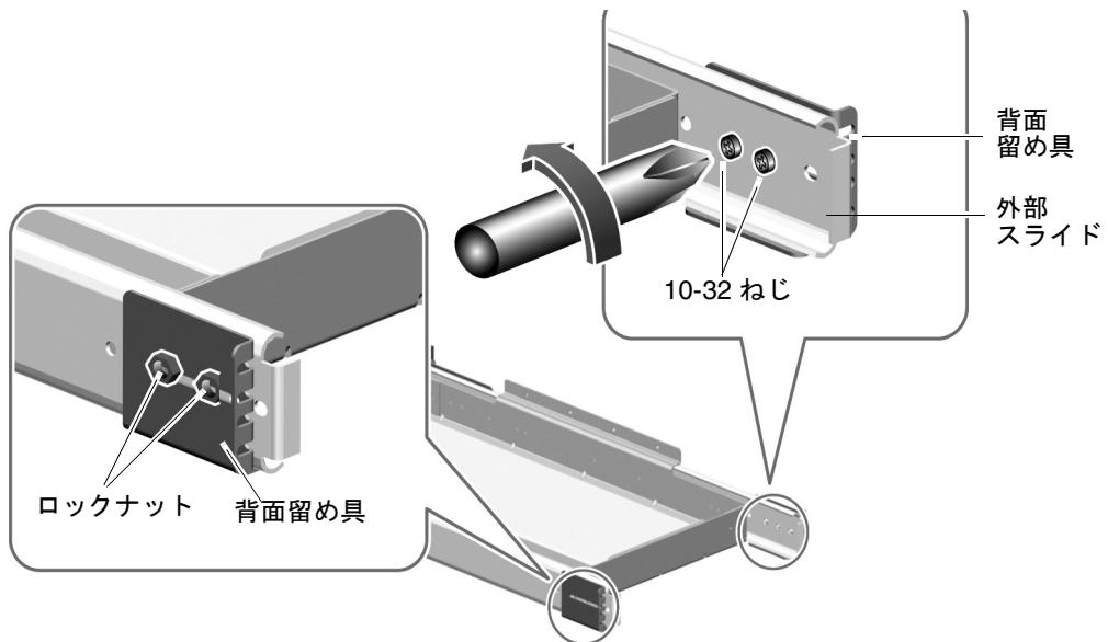
4. それぞれの短い背面留め具に 2 本の 10-32 ねじとロックナットを使用して、外部スライドに短い背面留め具を取り付けます。
