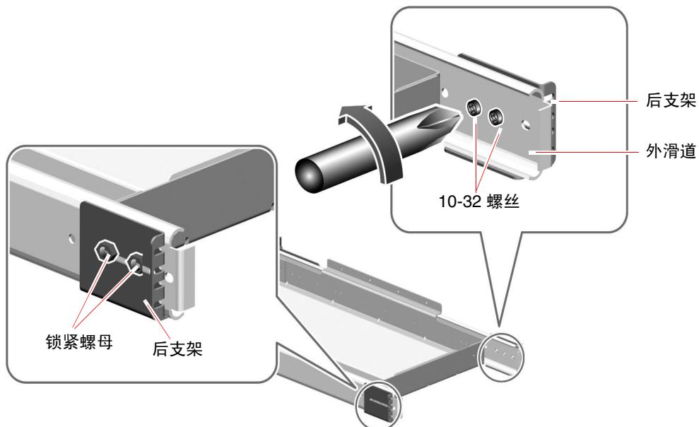
**4. 使用每个短后支架的两个 10-32 螺丝和锁紧螺母将短后支架连接到外滑道上。**
