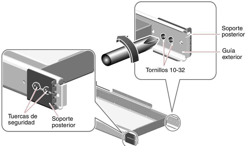
4. Coloque los soportes posteriores cortos en las guías exteriores asegurando cada soporte con dos tornillos 10-32 y tuercas de seguridad.
