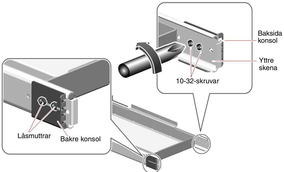
4. Fäst de korta bakre konsolerna vid de yttre skenorna med två 10-32-skruvar och låsmuttrar för varje kort bakre konsol.
