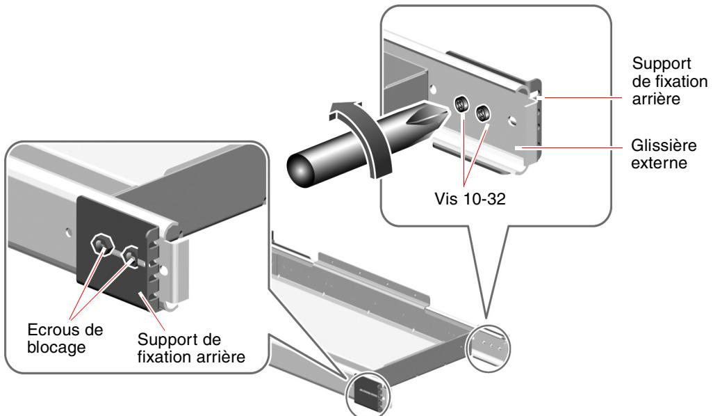
4. Installez les supports de fixation arrière courts sur les glissières externes à l'aide de deux vis 10-32 et d'écrous de blocage (deux vis par support).
