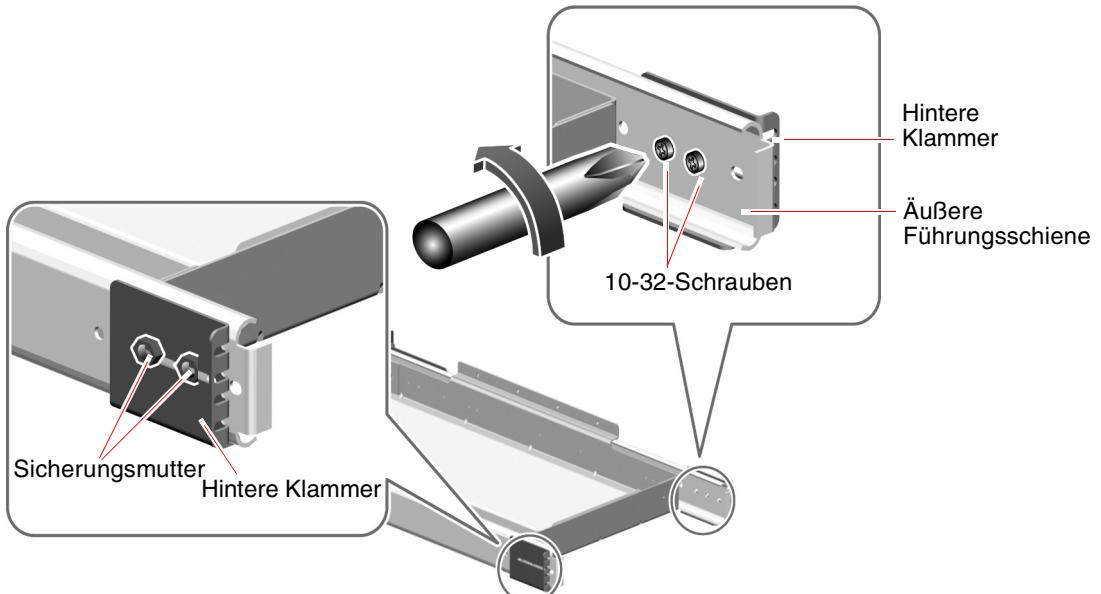
4. Befestigen Sie die kurzen hinteren Klammer mit zwei 10-32-Schrauben und Sicherungsmuttern pro kurze Klammer an den Außenführungsschienen.
