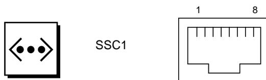
FIGURE B-5 RJ45 TPE Socket
